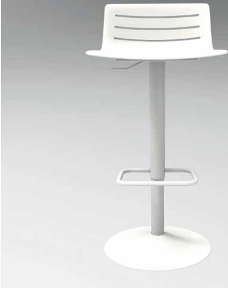
Taburete pie central para uso interior. Carcasa inyectada en PP con fibra de vidrio. Estructura de acero cromado o pintado blanco. Taburete giratorio con altura regulable con pistón de gas. Peso neto: 7,70 kg. Hs 56-77. H 79-100.
