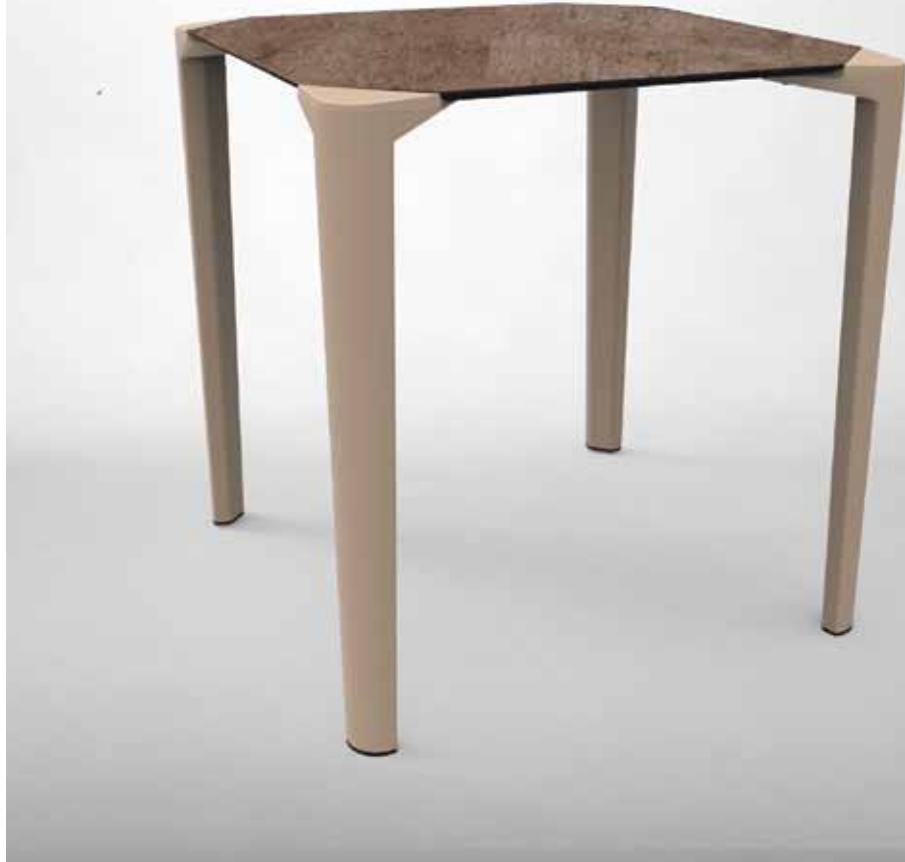
Patas inyectadas en polipropileno con fibra de vidrio mediante tecnología de moldeo asistida por gas. Altura 73,5 cm. Combinables con sobre de compacto fenólico en distintas medidas. Posibilidad en 3 o 4 patas según medida del sobre.
