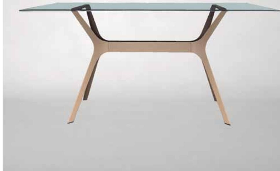
Pie central doble para uso interior y exterior compuesto por dos bases inyectadas en fibra de vidrio con PP mediante tecnología de moldeo asistida por gas, enlazadas entre sí por una barra de aluminio cubierto por un perfil de pvc texturizado. Protección UV. Peso neto 5,9 kg. Base compatible con sobres de compacto fenólico de 180 x 90 y 200 x 90, y cristal templado de 180 x 90 cm. Ver tabla de combinaciones en página 164.
