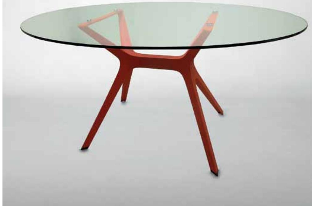
Pie central doble para uso interior y exterior compuesto por dos bases inyectadas en fibra de vidrio con PP mediante tecnología de moldeo asistida por gas, enlazadas entre sí por una barra de aluminio cubierta por un perfil de pvc texturizado. Protección UV. Peso neto 4,65 kg. Base compatible con sobres de compacto fenólico de 120 x 80 y cristal templado de 120 x 80 y de 150 x 110 ovalado. Ver tabla de combinaciones en página 164.
