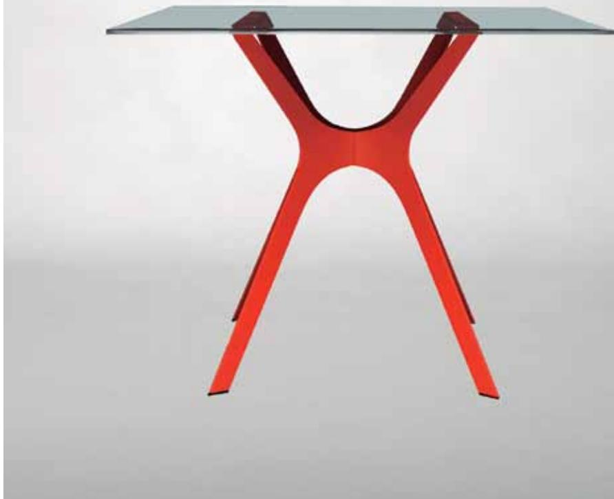
Pie central para uso interior y exterior compuesto por dos bases inyectadas en fibra de vidrio con PP mediante tecnología de moldeo asistida por gas, unidas por una barra de aluminio. Protección UV. Peso neto 4 kg. Pie compatible con sobres de compacto fenólico y cristal templado de 70 x 70, 80 x 80, 90 x 90, Ø70, Ø80 y Ø90. Ver tabla de combinaciones en página 164.
