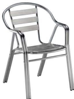
Sillón apilable para exterior. Estructura tubular doble, ø 25 x 1,20 mm de grosor, de aluminio anodizado brillante. Asiento y respaldo en lamas de aluminio estriado brillante. Tornillos de acero inoxidable, tuercas autoblocantes y conectores de aluminio.
